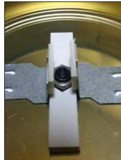
ナットの固定用にL字の金属板を接着。金属板はパソコンのカードスロット挿入口をふさぐための部品があまっていたものを流用。金ノコでカットして万能ボンドで接着。
